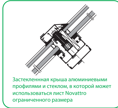
Типовое остекление с комбинированным использованием деревянных и алюминиевых профилей и соответствующих EPDM-резиновых уплотнителей
