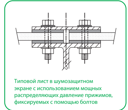
Установка листа с помощью болтов, шайб и тонких EPDM-резиновых уплотняющих колец
